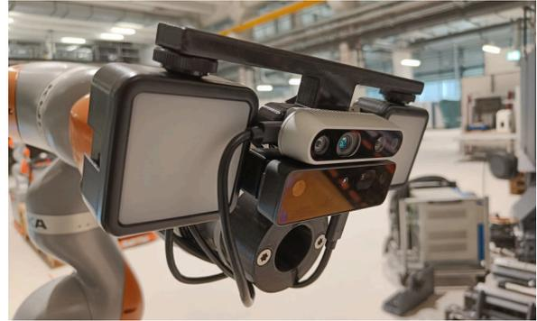
(b) Montierter Halter mit Sensoren und Lichtern
